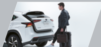
Porta-malas com abertura e fechamento elétrico e sistema hands-free (abertura por sensor de movimento)
