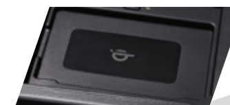
Carregador sem fio para smartphones Somente para aparelhos smartphones que possuem a tecnologia de recarga sem fio (wireless). O carregamento deve ser feito com o aparelho sem capa protetora ou com uma própria para carregamento de bateria sem fio (wireless). Consulte as especificações técnicas de seu aparelho
